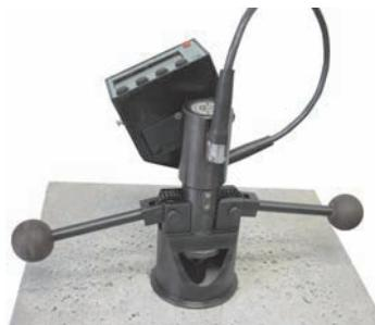
Рисунок П.15- Измеритель прочности ячеистых бетонов ПОС-2МГ4П
