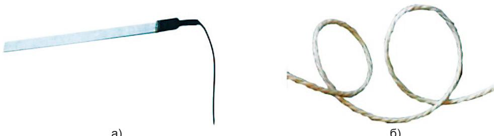
а) – стальной стержень; б) – канат с проводами из нержавеющей стали
