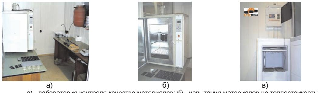
а) - лаборатория контроля качества материалов; б) - испытания материалов на теплостойкость;
