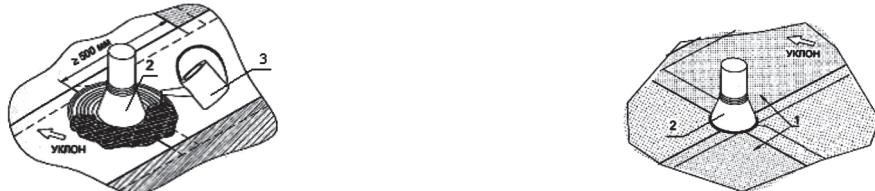
1 – полотница второго слоя основного покрытия; 2 – труба; 3 – битумно-полимерная мастика.
