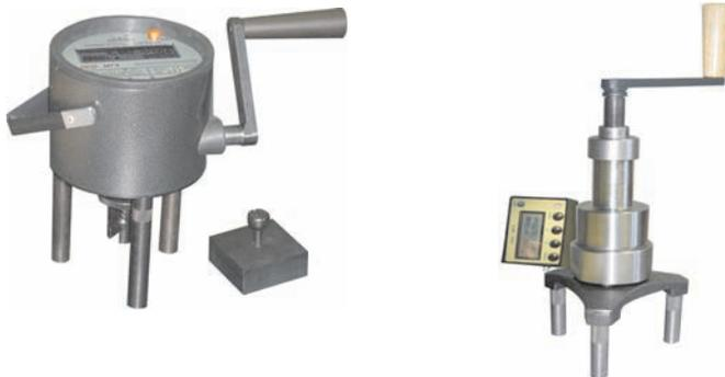
Рисунок П.8 - Измерители адгезии приборы ПСО-1МГ4, ПСО-2,5МГ4
