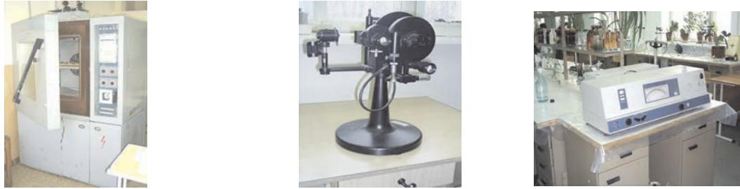
а) - установка для испытания материалов на искусственное старение (АИП); б) – пиromетр; в) – спектрофотометр.
