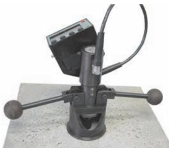
Рисунок П.15- Измеритель прочности ячеистых бетонов ПОС-2МГ4П
