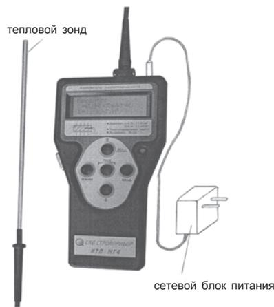
Рисунок П.2 - Общий вид прибора ИТП-МГ4 «Зонд»
