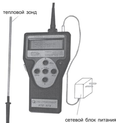
Рисунок П.2 - Общий вид прибора ИТП-МГ4 «Зонд»
