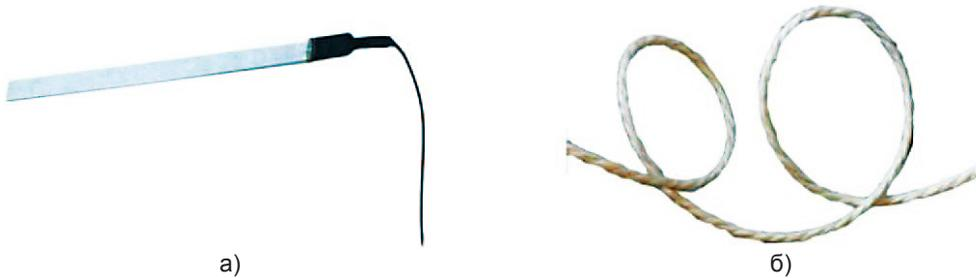
а) – стальной стержень; б) – канат с проводами из нержавеющей стали
