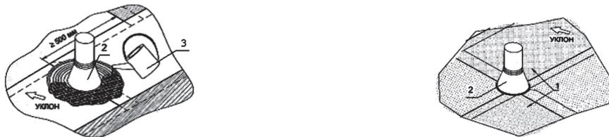
1 – полотнища второго слоя основного покрытия; 2 – труба; 3 – битумно-полимерная мастика.
