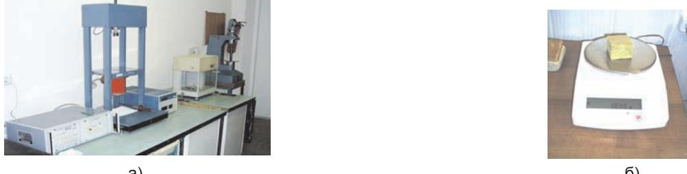
а) – твердомер, приборы для измерения текучести, массы; б) – испытание образца теплоизоляции.
